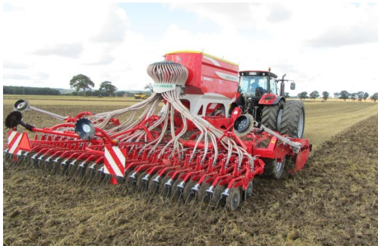
Figur 6.17: Såning med skiveskærssåmaskine hvor jordbearbejdning og såning foretages i én arbejdsgang. Foto: Henning Sjørsløv Lyngvig
