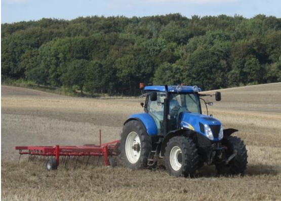
Figur 6.2: Strigling bør foregå på skrå af normal arbejdsretning og gerne med høj fart. Foto: Hans Henrik Pedersen.
