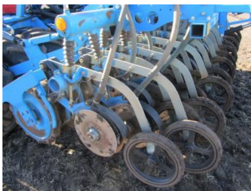
Figur 6.18: Skiveskær på Lemken Solitair. Dybdestyringshjulet er monteret efter skiveskæret. Foto: Henning Sjørsløv Lyngvig
