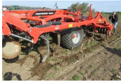
Figur 6.10: Stive tænder muliggør harvning i 25-35 cm dybde. Foto: Henning Sjørsløv Lyngvig
