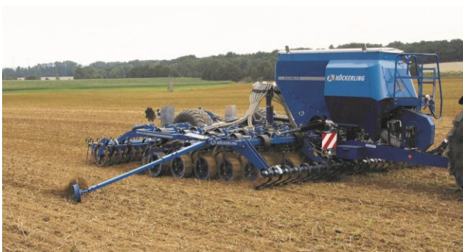
Figur 6.22 og Figur 6.23: Köckerling Ultima CS har et dybdestyringshjul foran hver såtand. Fotos: Köckerling
