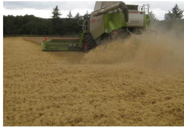
Figur 6.1: Her ses en god spredning i fuld bredde, det er med til at sikre en jævn fordeling af næringsstoffer og mulighed for bedre omsætning af halm og stub. Foto: Stroco Agro.
