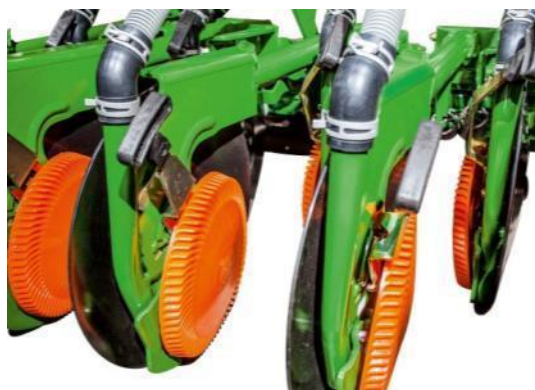
Figur 6.19: Skiveskær på Amazone Cirrus. Dybdestyringshjulet er monteret på siden af skiveskæret. Foto: Amazone
